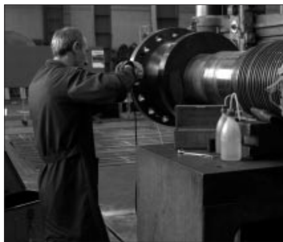
Un dipendente Tosi al lavoro sul rotore di una turbina
